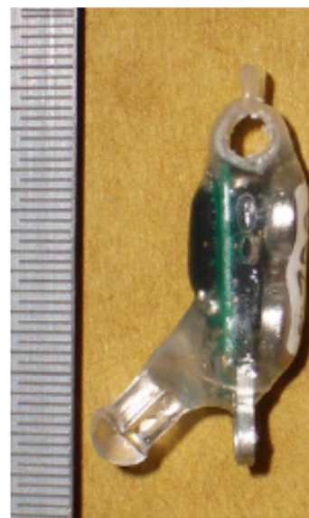
Figure 2 (à droite). En 2015, nous avons utilisé des photomètres INTIGEO P65C2-7 pesant 0.74g fournis par Migrate Technology.
