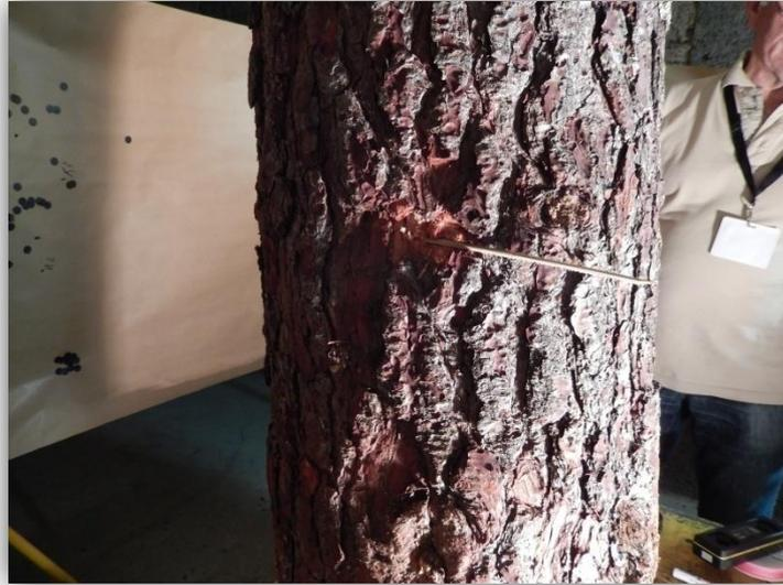
La pénétration moyenne d'un grain de chevrotine dans le pin est de 3,2cm.
