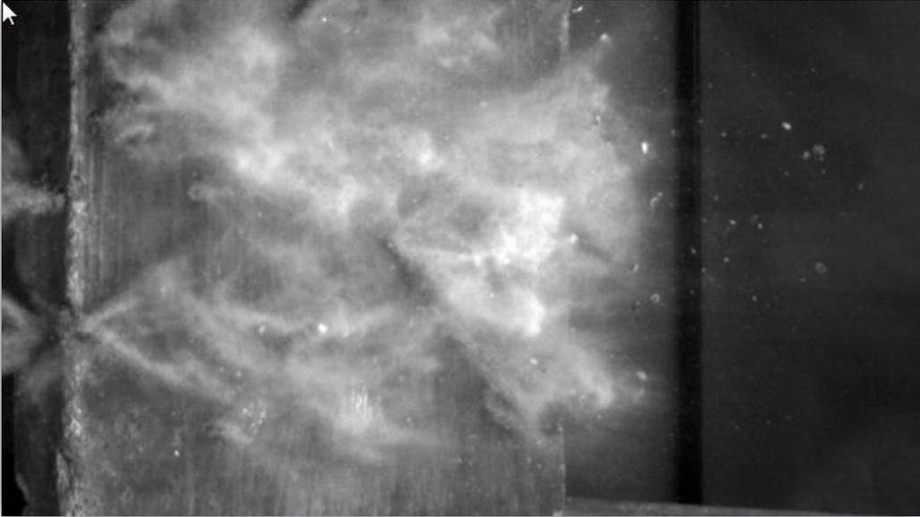
Groupement des éclats divers et des grains ayant ricoché sur la plaque de béton
