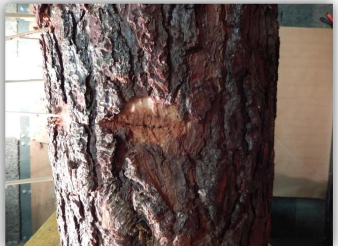
Trajectoire tangentielle sur le côté droit, rectiligne, sans qu'un ricochet n'en résulte.
