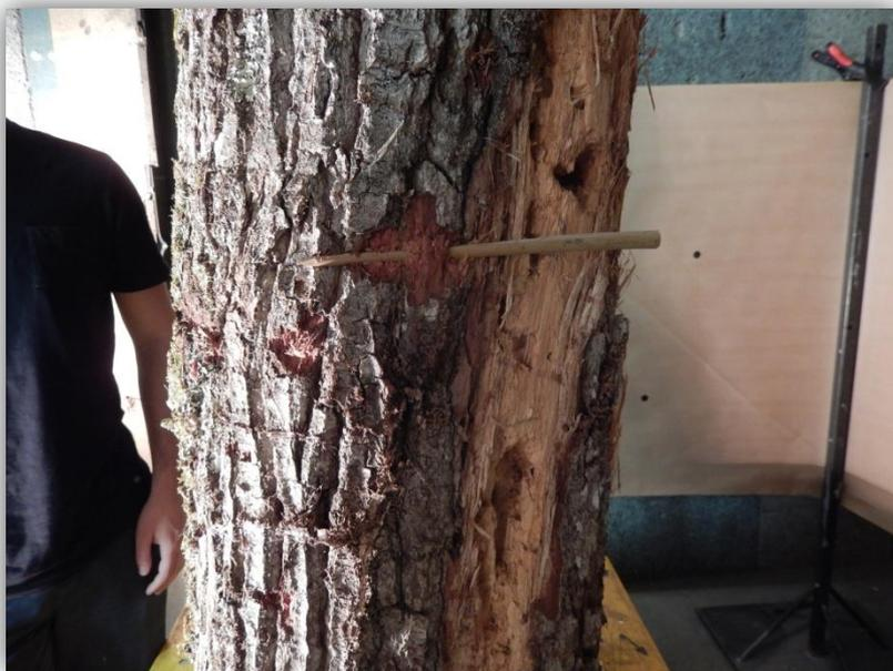
La profondeur moyenne de pénétration des grains est de 36 mm.
