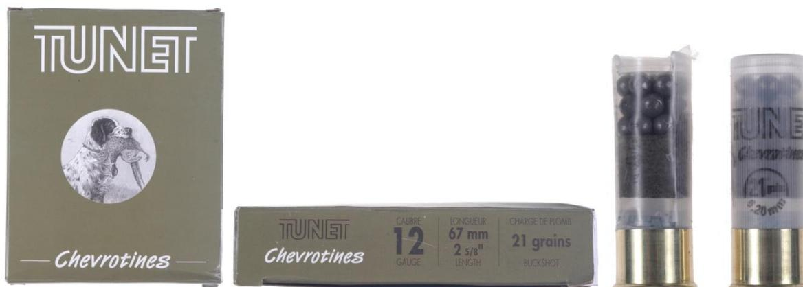
Chaque cartouche est constituée par un culot en acier laitonné d'une hauteur de 16 mm, ceinturant et renforçant la base du bobineau en matière plastique translucide striée en long; une rondelle intercalaire en matière plastique translucide sépare la charge propulsive de la bourre de type grasse.
