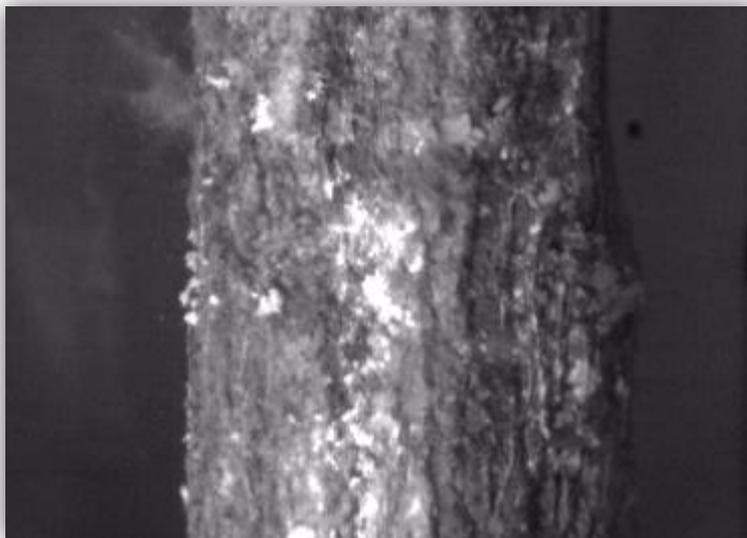
La profondeur de la pénétration des grains est de 41 mm.
