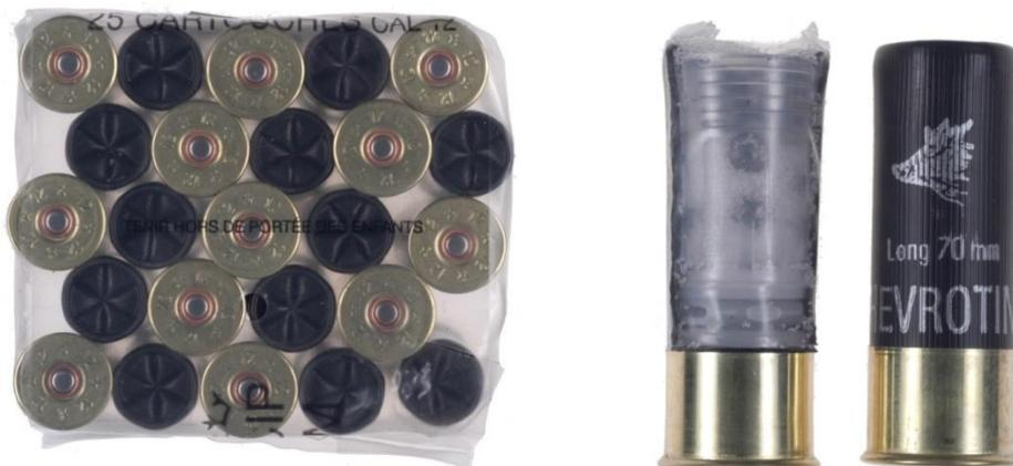
Chaque cartouche est constituée par un culot en acier laitonné ceinturant et renforçant la base du bobineau, mesurant 16 mm de haut ; une bourre à godet à 2 pétales, à jupe avec amortisseur contenant entièrement 21 grains de chevrotines, répartis sur environ 5 lits de grains de plomb noyés dans des grains de poudre polymère ; chaque grain mesure en moyenne 6,20 mm de diamètre, pour une masse moyenne de 1,42 grammes. Le bord supérieur du bobineau est replié en étoile pour sertir l'ensemble.
